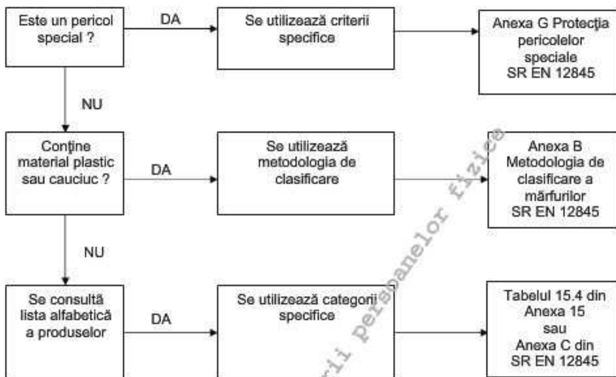
Figura 7.2. Schemă de determinare a claselor de pericol la incendiu pentru depozite (conform SR EN 12845)
