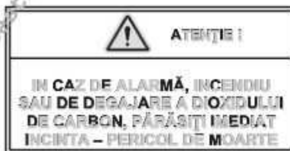
Figura 14.1. Indicator pentru avertizare asupra faptului că spațiile sunt protejate cu dioxid de carbon
